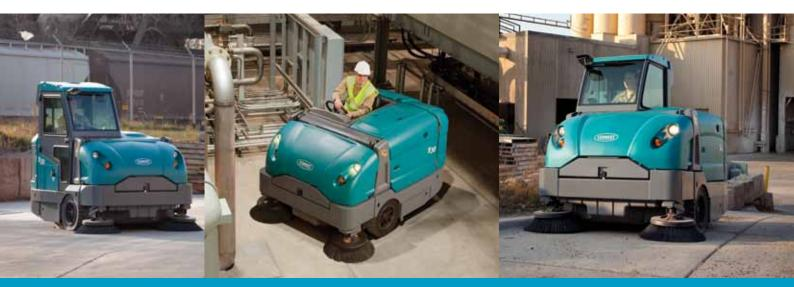
Diseñada para un barrido industrial confiable, la barredora S30 de operador sentado de Tennant mejora el rendimiento en interiores y exteriores, reduce considerablemente los niveles de ruido y viene con un exclusivo sistema de control de polvo SweepSmart™.
